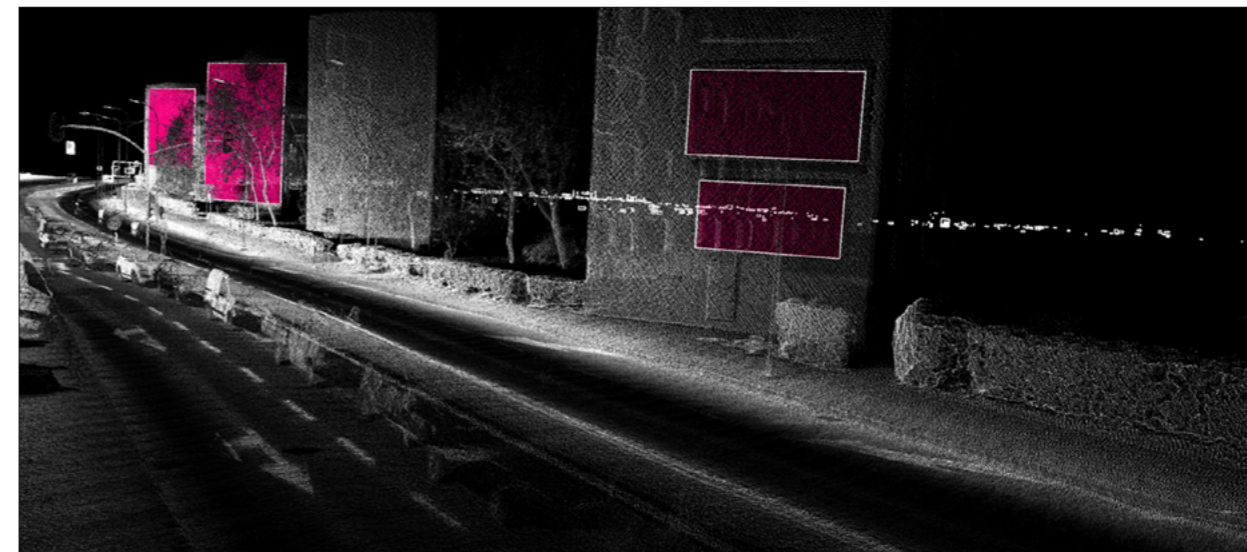
Ryc. 2.3. Chmura punktów z mobilnego skaningu laserowego z inwentaryzacją reklam
